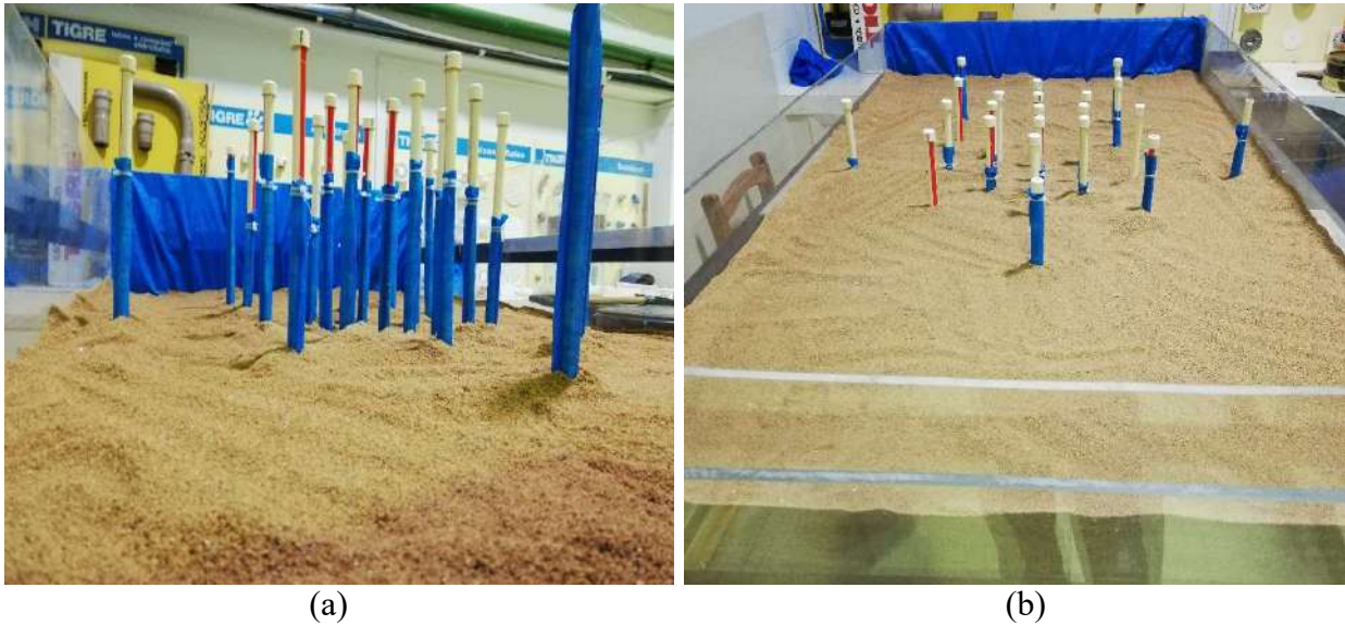
Figura 2 – (a) Piezômetros cubertos com tecido filtrante; (b) Tanque preenchido com ele meio poroso
