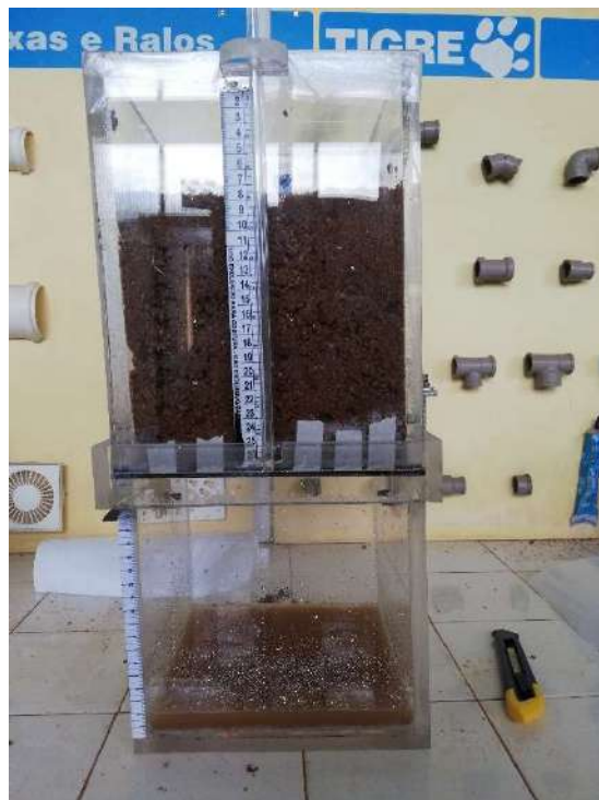
Figura 7 –Cubo de drenaje
